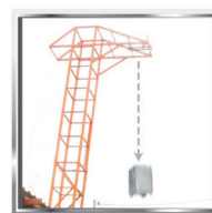
หลังการเผาไหม้ ตู้ยังคงแข็งแรงแม้ตก จากความสูง ระดับ 4 เมตร Lifted the safe up at 4 meters high and performed a drop test
